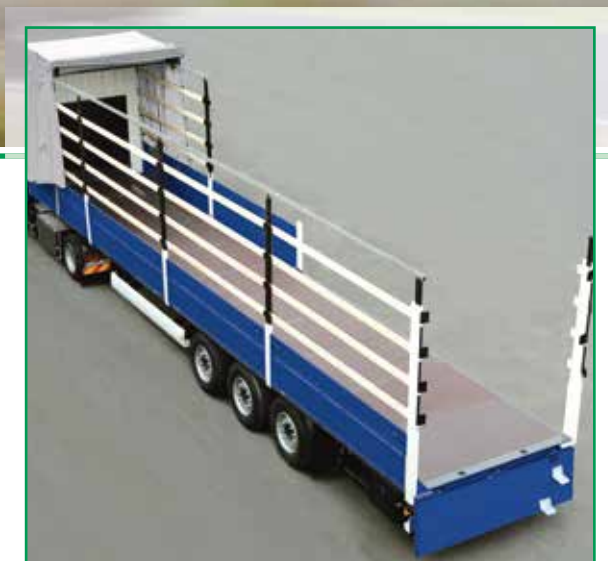
Stahl-Laufschienen Segmente abnehmbar. Paket auf Wunsch abgestützt. Steel running rail segments removable. Package supported upon request.
