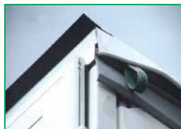
Edscha TS-Verdeck mit klappbarem und mitlaufendem Portalbalken inkl. Regenleiste Edscha TS roof with folding and travelling gantry beam, including weather strip
