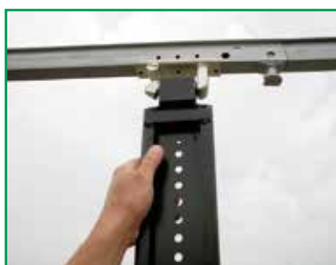
Edscha TS Topkupplung Edscha TS top coupling
