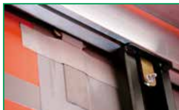
Runnenwagen und Planenroller mit reibungsreduzierender Auflage Pillar glider and tarpaulin roller with reduced-friction support
