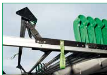
Äußerst haltbare Kunststoffgelenke Extremely durable plastic joints
