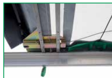
Hinteres Verdeckende mit Edscha TS-Portalbalken, Seilanbindung und Verriegelung Rear end of roof with Edscha TS gantry beam, cable connection and lock
