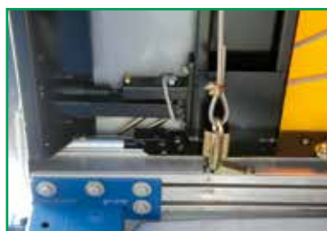
Zugseilverriegelung mit Keil Pullrope closure with wedge
