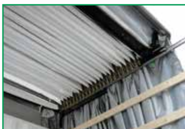
Durch Gelenke zuverlässige gefaltete Plane Tarpaulin reliably folded through joints
