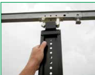
Edscha TS Topkupplung Edscha TS top coupling
